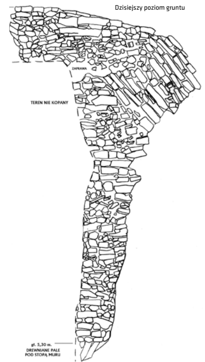
Profil badanego fundamentu arkadowego
